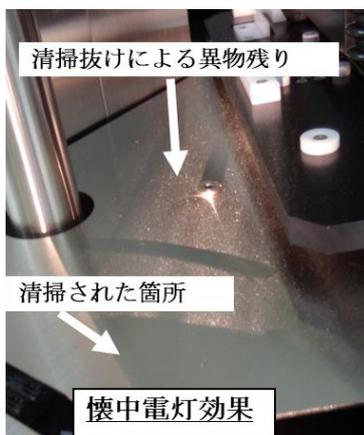
図2 懐中電灯を使った異物の見える化例
